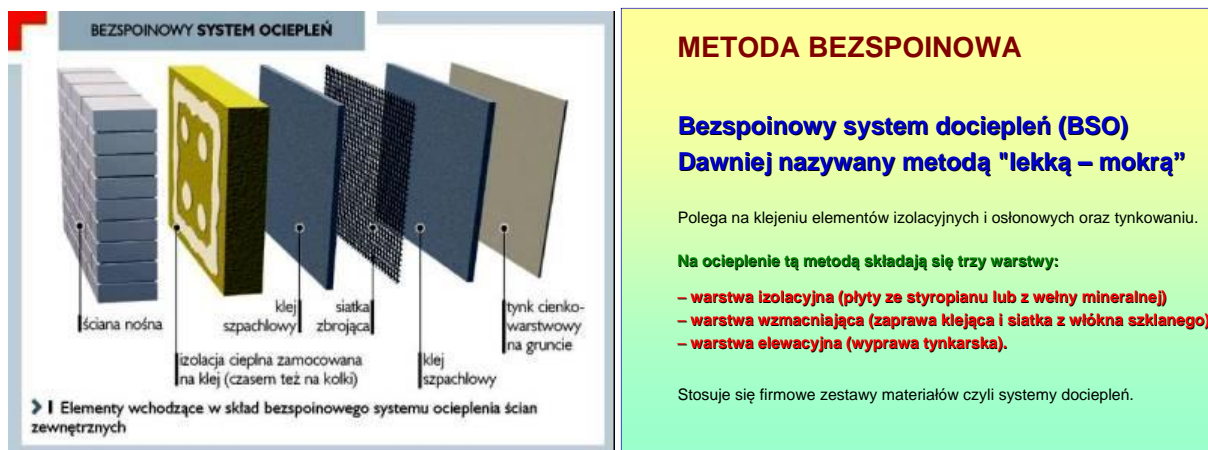
Rys. 1 Bezspoinowy system dociepleń (BSO)
