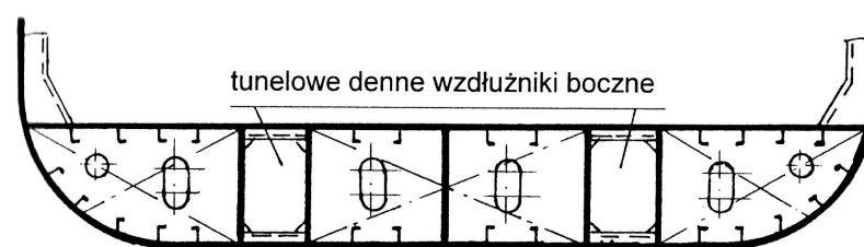
Rys. 8. Dno podwójne statku z dennymi bocznymi wzdłużnikami typu tunelowego
