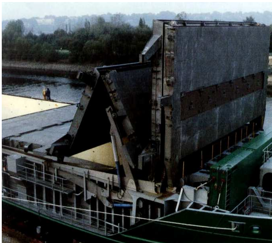
Otwieranie pokrywy typu foldtite, składającej się z trzech par paneli.
