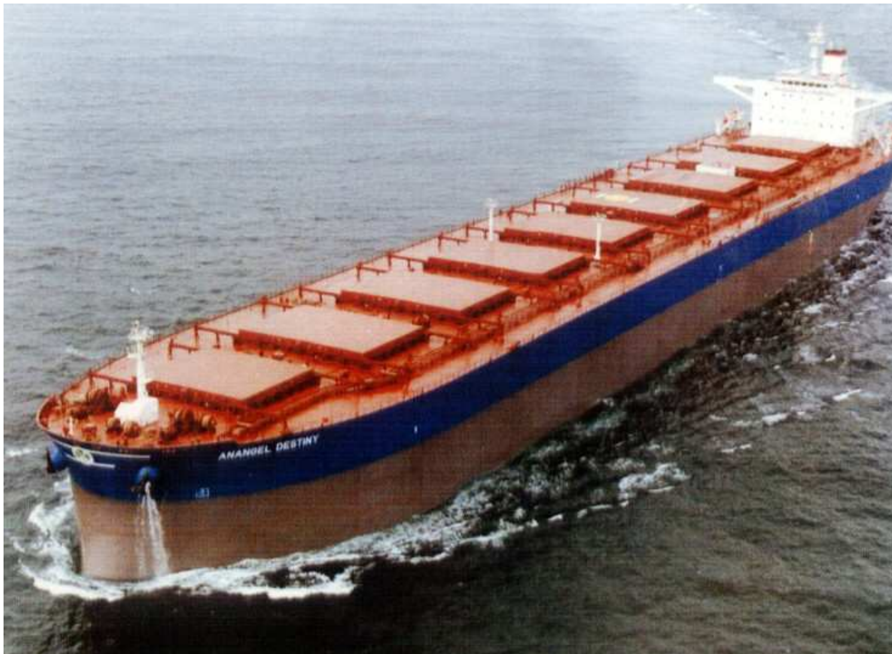
Masowiec typu cape-sized (100000÷180000 ton nośności)
