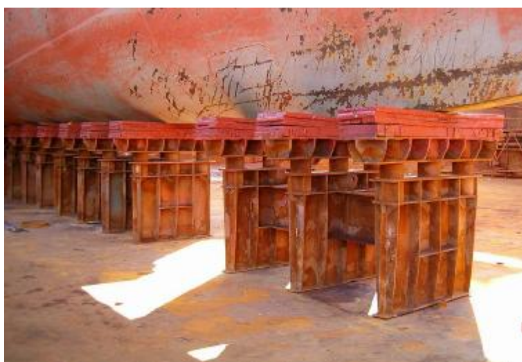
Rys. 3. Kilbloki podpierające statek na pokładzie doku pływającego [10]
