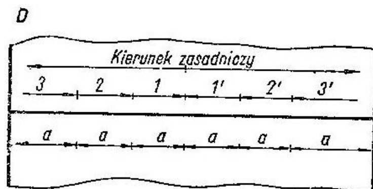
Rys. 21. Krokowo-wsteczna metoda spawania złącz czołowych a — spawanie przez jednego spawacza; b — spawanie przez dwóch spawaczy
