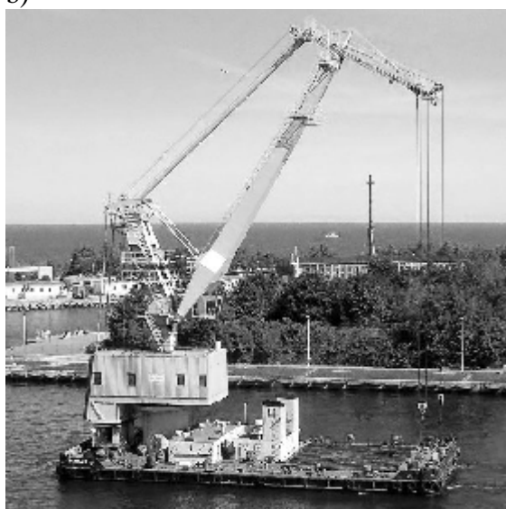
Rys. 10. Urządzenia techniczne stosowane w stocznich remontowych: a) doki pływające, b) żuraw pływający o udźwigu 100 t z możliwością obrotu ramienia wokół osi pionowej o 360°, c) żuraw pływający o udźwigu 220 t (bez możliwości obrotu ramienia) [6]
