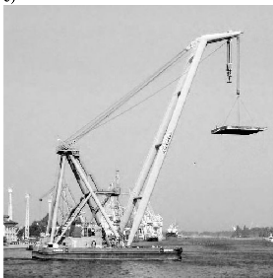
Rys. 10. Urządzenia techniczne stosowane w stocznich remontowych: a) doki pływające, b) żuraw pływający o udźwigu 100 t z możliwością obrotu ramienia wokół osi pionowej o 360°, c) żuraw pływający o udźwigu 220 t (bez możliwości obrotu ramienia) [6]
