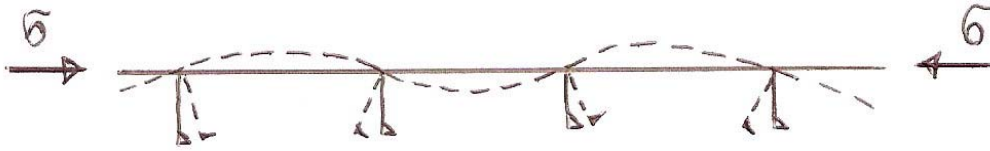
Rys. VII.8 Wyboczenie ściskanego poszycia podpartego przez usztywnienia
