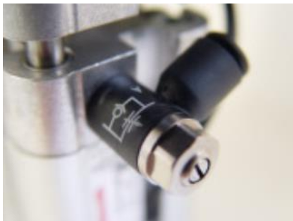
Rys.8 Widok konstrukcji modułu i śruby regulacyjnej
