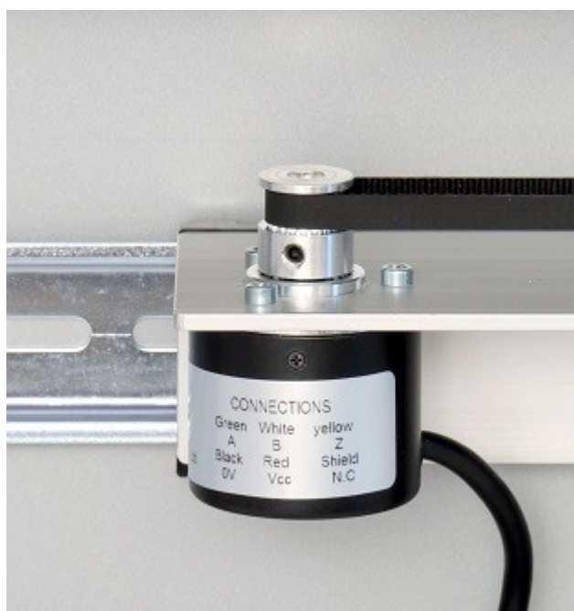
Rys. 7: Enkoder inkrementalny N38G6-400-BM-8-30F2
